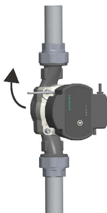
5) Відрегулювати в потрібному напрямку, зафіксувати шестигранними болтами
