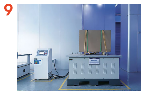
Машина для випробування на електромагнітну вібрацію
