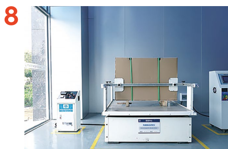
Прилад для випробування на вібрацію під час транспортування
